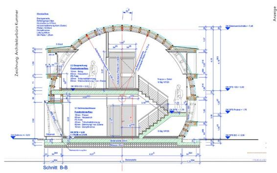
Die Schnittzeichnung aus einer frühen Planungsphase zeigt den grundsätzlichen Aufbau des Gebäudes. Einige Ausführungsdetails wurden in intensiver Zusammenarbeit zwischen Architekt und Spengler später optimiert
